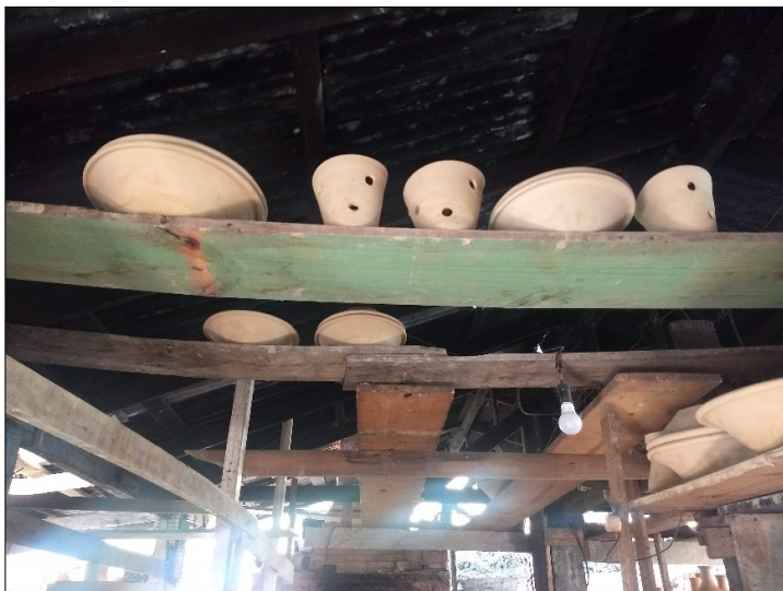
Figura 7: Tendais em madeira suspensos, próximos ao telhado enegrecido da olaria, para secagem das peças. Foto: Edmara Schuch, out. 2019.
