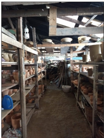
Figura 5: Interior da olaria tradicional de Moacir “Ci”, com estantes em madeira para secagem de peças ou para as peças prontas, e chão batido. Foto: Edmara Schuch, out. 2019.
